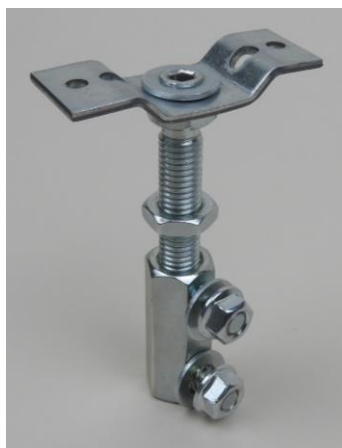
Ilustracja 68: Element regulacyjny WU M 12x70-F, regulowany od góry, dołu i boku
